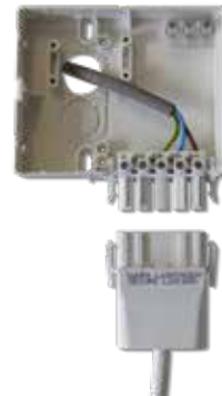
Obr. 93 Připojení se provádí pomocí nástěnné zásuvky, která je součástí balení. Pokud použijete kryt na ochranu proti stříkající vodě, který lze zakoupit jako příslušenství, lze druh ochrany zvýšit na IP 44.
