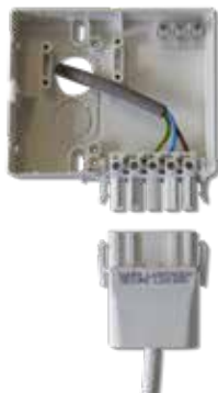
Obr. 87 Připojení se provádí pomocí nástěnné zásuvky, která je součástí balení. Pokud použijete kryt na ochranu proti stříkající vodě, který lze zakoupit jako příslušenství, lze druh ochrany zvýšit na IP 44.
