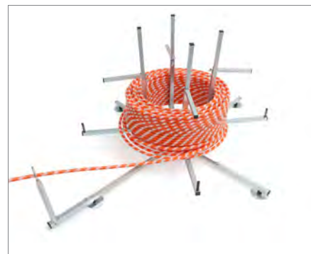
Odvíjecí zařízení pro pokládku trubek
