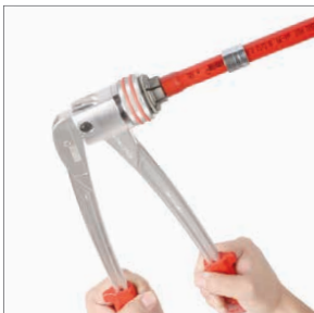
3. Rozšíření trubky zastudena expandérem 2x. Druhé rozšíření po otočení expandéru o 30°.
