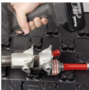
3. Rozšíření trubek expandérem.
