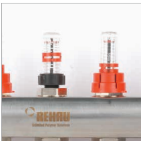
3. Nastavení potřebného průtoku dle projektu 0,5 – 5 l/min otáčením černé matice průtokoměru.
