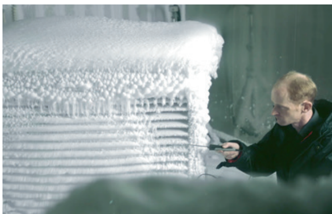
Testování jednotky v extrémních klimatických podmínkách v chladicí komoře.
