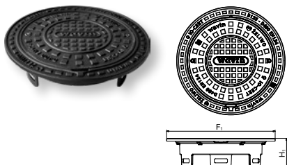
Litinový poklop D400 Ø 425 mm – kulatý do teleskopické roury
